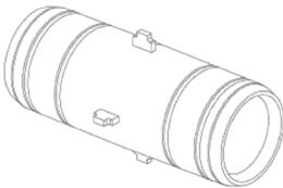
X-образное кольцо для центровки модулей внутри корпуса;
